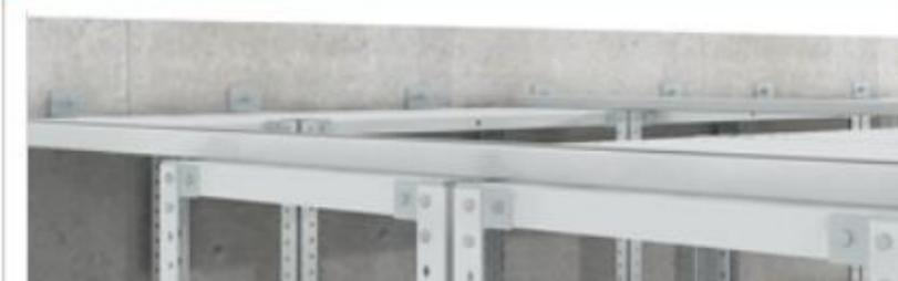
ラック同士をつなぐことで、ひとつのブロックとして不規則な地震の揺れから物品棚の転倒・横ずれを防止します。端部は壁にアンカーボルトで固定します。一般的には棚の奥行き方向をつなぎます。間口方向をつなぐと、さらに耐震性能が増します。
