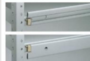
カードホルダー兼回転式落下防止装置です。通常はホルダーを上げておき、格納物を出し入れする時は下に回転してホルダーを降ろします。
